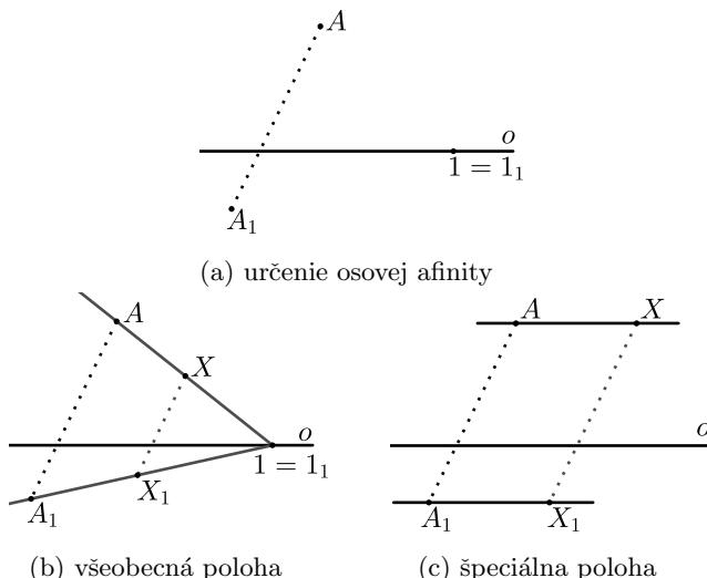
Obr. 2: Osová afinita s osou  $o$  a určujúcou dvojicou bodov  $(A, A_1)$ .
