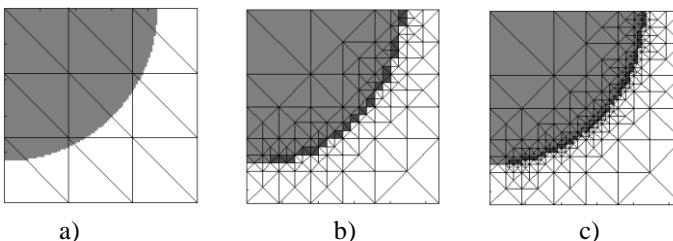
Obr. 3: Lokálne zjemnenie  $RTIN_P$  na testovacej geometrii
