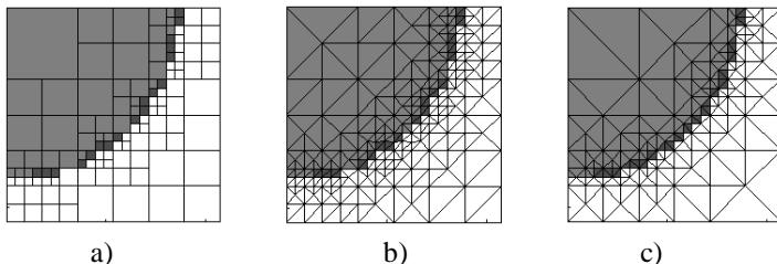
Obr. 5: Lokálne zjemnenie  $RTIN_Q$  na testovacej geometrii.
