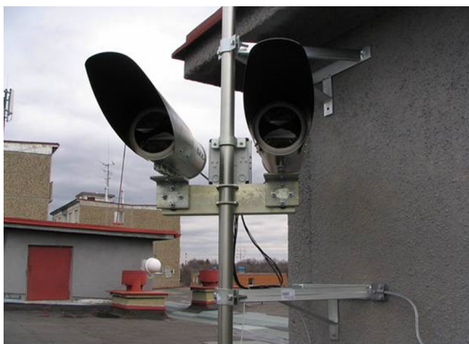
Obr. 7: Jednotka bezdrátové optické sítě RONJA Zdroj: [1]
