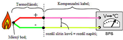
Obr. 3: Soustava pro měření teploty termočlánkem Zdroj: Günther GmbH: Kompenzační kabely [online]. Schwaig, 2013 (cit. 16. 7. 2016) Dostupné z: https://www.guenther.eu/c27c2870-fc76-0a5f-c347-6e2c73422d81?Edition=cz
